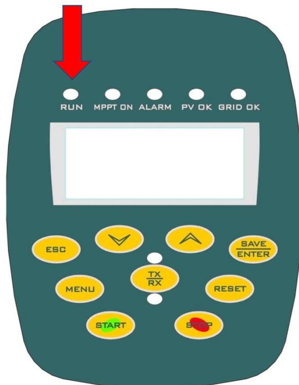
Figura 8: LED RUN sul display/keypad
