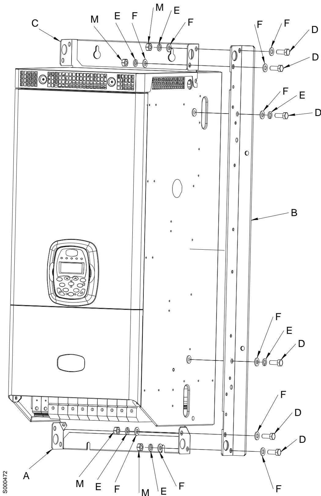
**Figura 4)**, facendo in modo che si formi il piano di appoggio alla parete, opportunamente preparata con asola per montaggio passante, su cui verrà fissato l'inverter. Non devono
