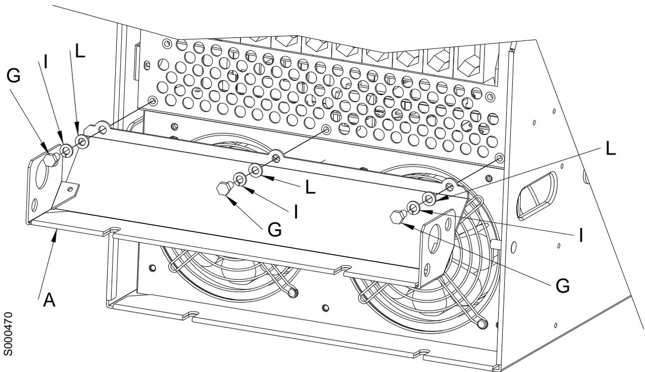
Figura 2: Montaggio parte "A"
