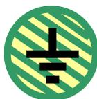
Connettere sempre l'inverter ad una linea di terra realizzata secondo le normative vigenti. Per minimizzare i disturbi condotti ed irradiati che è possibile che vengano emessi dall'inverter è preferibile collegare il conduttore di terra del motore direttamente all'inverter, con un percorso parallelo a quello dei cavi di alimentazione del motore, e da qui all'impianto elettrico.
