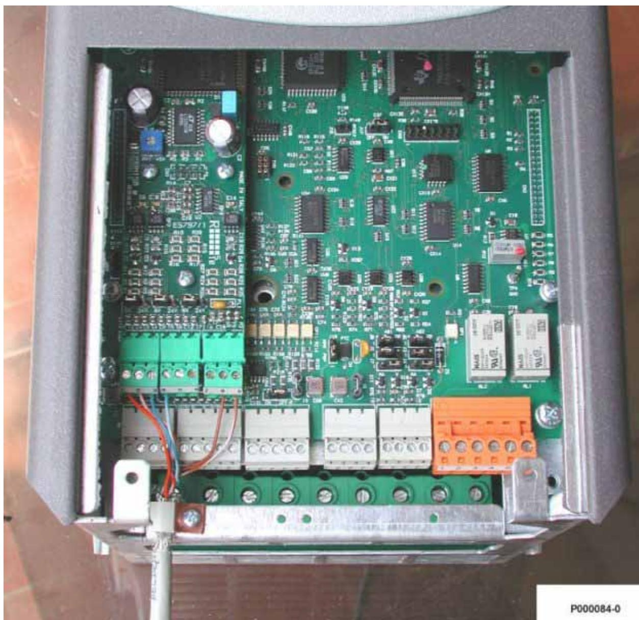
**Figura 85: Collegamento del cavo encoder**
