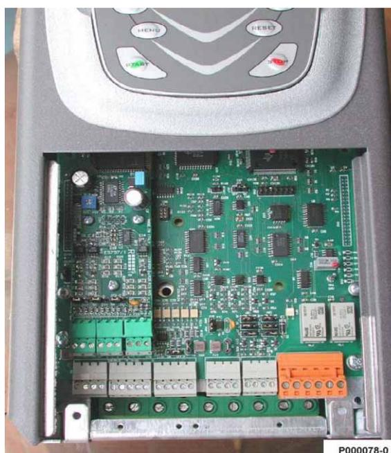
Figura 79: Scheda encoder fissata nello slot
