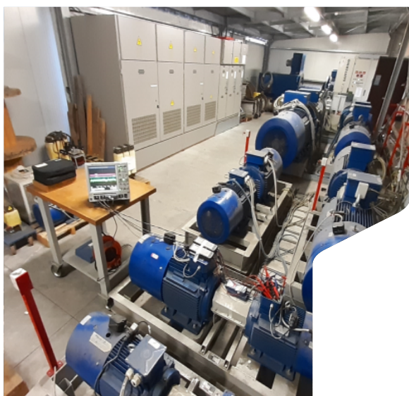
Figura 3 – Sala motori con coppie motore-freno da 10 a 800kW
