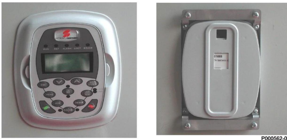
Figura 82: Viste anteriore / posteriore della tastiera e relativo guscio, fissati sul pannello.
