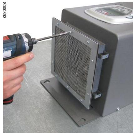
5. Pulire il filtro di aspirazione dell'aria e, se necessario, sostituirlo.
