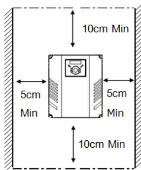
Deixar espaço suficiente para fazer correr o ar de resfriamento entre o condutor dos cabos e o inversor
