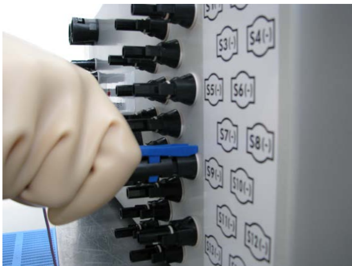
Figura 30: Disconnessione connettore stringhe
